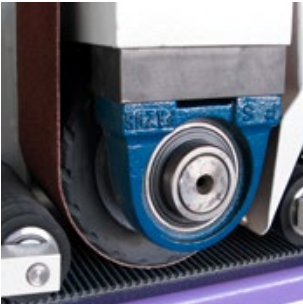
___ estação com cinta de lixa para remoção de imperfeições e acabamento de superfície para tubo retangular, barras e pequenas chapas
