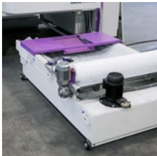
___ o filtro automático assegura uma renovação contínua do papel filtrante
