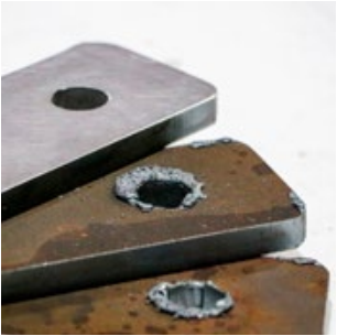
___ arestas suaves devido a duas correias com blocos abrasivos operando em sentido opostos
