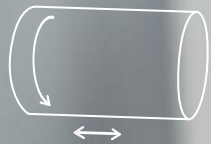
oscilação horizontal que melhora a duração da lixa
