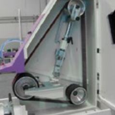
__ lixadora com cinta de lixa para fazer a preparação da superfície de tubos redondos
