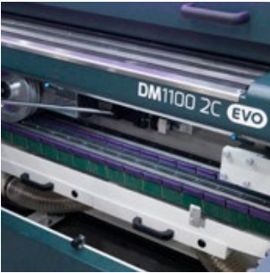
__ arredondamento de ambos os lados de peças após corte de laser, punção ou jato de água
