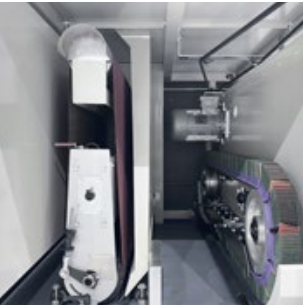
— remoção de rebarba e arredondamento de arestas com uma lixa com rolo de contacto e o sistema de blocos abrasivos
