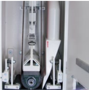
___ FC120 Z disponível com apenas a estação com cinta de lixa
