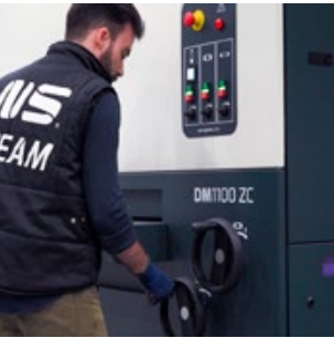
— volantes integrados na máquina para ajustes rápidos, intuitivos e precisos da espessura e pressão
