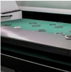
__ arredondamento de uma face em peças desde 50x50mm graças à tela adicional e mesa de suporte
