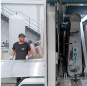
___ estação dupla ou tripla com cinta de lixa e escova de acabamento (2ZK e 3ZK)
