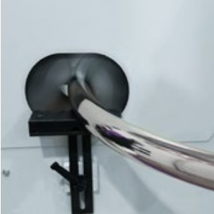
__ capaz de processar tubos retos (automaticamente) e tubos curvados (manualmente) simplesmente movendo a alimentação
