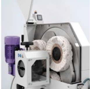
__ sistema planetário para polimento com três discos que giram em torno do tubo, com aplicação de alta pressão
