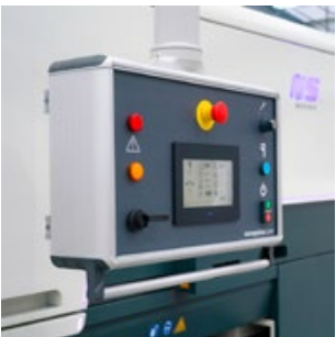
___ controlar as estações ativas, velocidade e espessura de trabalho para ambas estações, controlo da flutuação e oscilação do tambor
