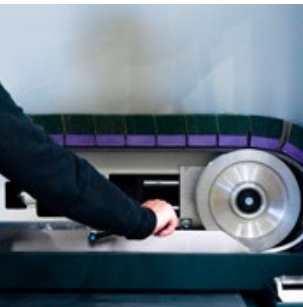
— volantes integrados na máquina para ajustes rápidos, intuitivos e precisos da espessura e pressão
