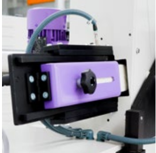
__ aplicação automática de sabão nos discos de polimento, manualmente pelo operador ou automaticamente com controlo de tempo
